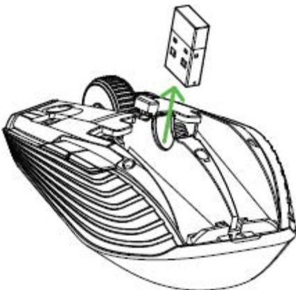
2. Закройте верхнюю крышку и подсоедините беспроводной USB-адаптер к USB-порту компьютера.
