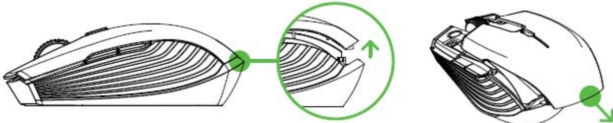
2. Вставьте две прилагаемые батарейки AA в Razer Atheris, соблюдая полярность, указанную в батарейном отсеке.
