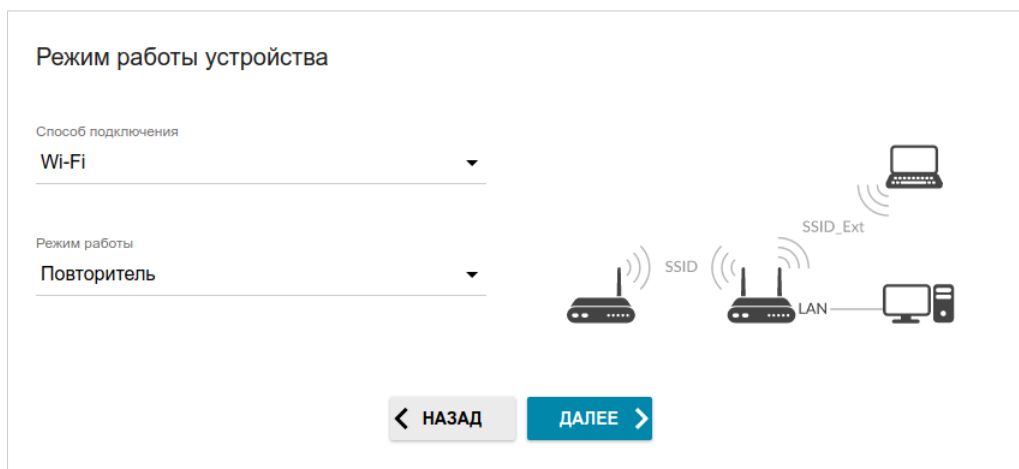
Рисунок 37. Выбор режима работы устройства. Режим Повторитель .
