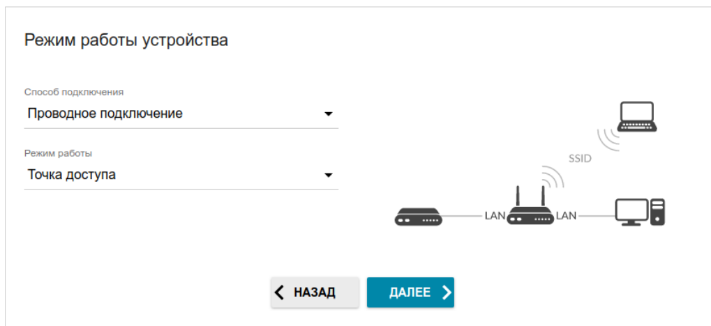
Рисунок 36. Выбор режима работы устройства. Режим Точка доступа .
