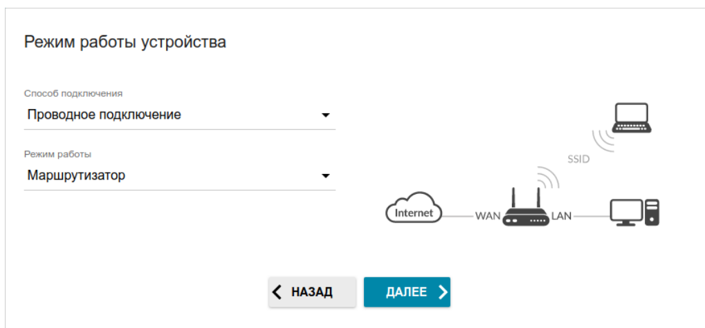
Рисунок 34. Выбор режима работы устройства. Режим Маршрутизатор .
