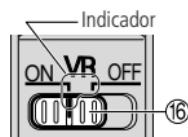
2 La vibración se reduce en el momento en que se presiona ligeramente el disparador. Como se reduce la vibración en el visor, es más fácil de hacer el enfoque automático/manual y el encuadre exacto del objeto.
