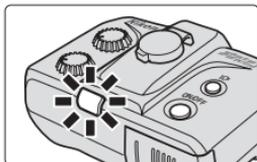
В режиме TTL, когда вспышка SB-R200 срабатывает на максимальной мощности и может иметь место недоэкспозиция, индикатор готовности на SB-R200 будет в течение примерно трех секунд мигать красным цветом. (Индикатор готовности в видоискателе фотокамеры не мигает.)
