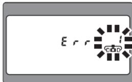
Если при использовании фотокамер, несовместимых с CLS, блок управления SU-800 и вспышка SB-R200 соединены с помощью кабеля неправильно, мигает индикатор Using cords (Использование кабеля).
