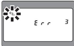
Блок управления SU-800 нельзя использовать с цифровыми фотокамерами серии COOLPIX. При попытке их использования в качестве предупреждения мигает индикатор функции беспроводной вспышки.
