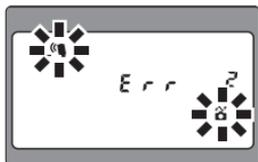
Если блок управления установлен на фотокамеру, несовместимую с CLS, то командный режим не работает. Отображение предупреждающих индикаторов, если установлен командный режим.
