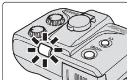
В режиме TTL, когда вспышка SB-R200 срабатывает на максимальной мощности и может иметь место недоэкспозиция, индикатор готовности на SB-R200 будет в течение примерно трех секунд мигать красным цветом. (Индикатор готовности на блоке управления SU-800 и в видоискателе фотокамеры не мигает.)
