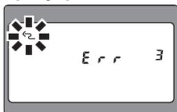
Блок управления SU-800 нельзя использовать с цифровыми фотокамерами серии COOLPIX. В качестве предупреждения мигает индикатор функции беспроводного управления вспышками.
