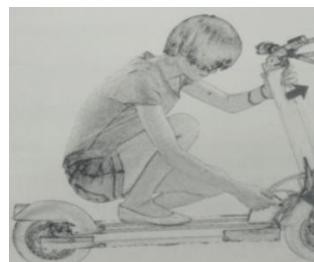
2. Толкните стойку вперед и одновременно потяните рычаг М
