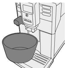
**Atenção:** quando inicia a preparação, o distribuidor de água quente poderá pulverizar vapor e água quente. Antes de remover o distribuidor de água quente, aguarde o final da preparação.
