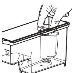
Insertar el filtro de agua "INTENZA+" en el depósito de agua vacío, empujándolo hasta el punto más bajo posible.
