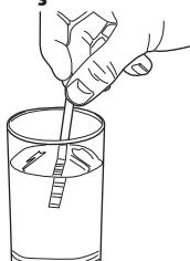
Utilize a tira para a medição da dureza de água fornecida.
