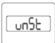
Весы установлены на неровную поверхность. Взвешивание невозможно.
