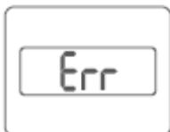
Индикатор перегрузки. Уберите лишний вес с платформы весов.
