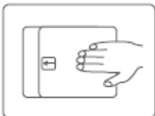
3. Закройте крышку отсека с батарейками.
