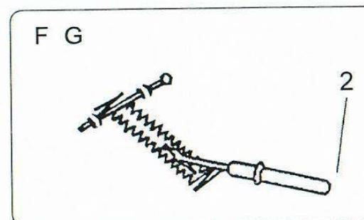
F. Снимите ткань с машинки и отрежьте строчные нитки.
