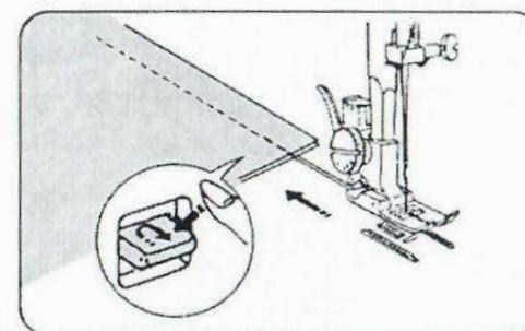
Для закрепления концов полос, нажать клавишу обратного прокладывания шва и сделать несколько стежков в обратном направлении.
