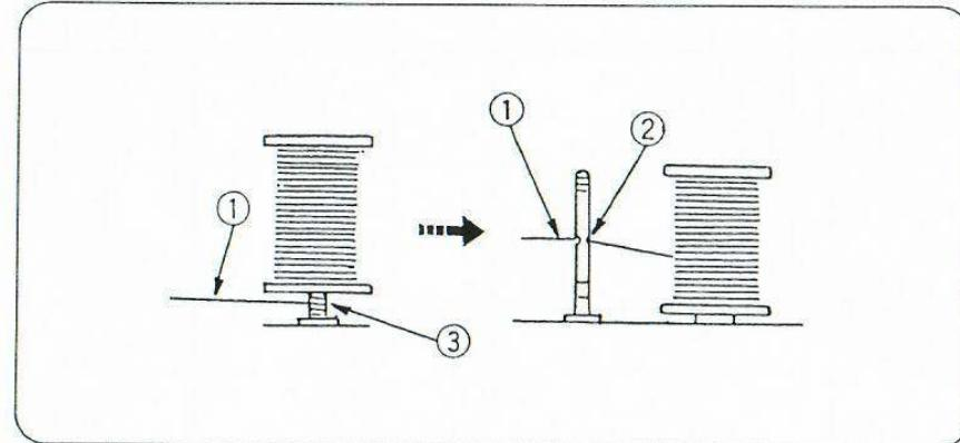
**ПРИМЕЧАНИЕ:** В случае использования нити с тенденцией делать петли вокруг штифта катушки, пропустить нить сквозь отверстие штифта катушки, как это показано на рисунке. Отверстие должно быть обращено к катушке с нитью.
