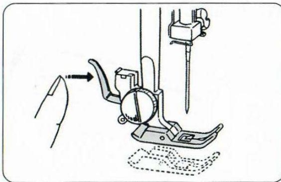
Нажать рычаг с задней стороны держателя лапки. Прижимная лапка поднимется.
