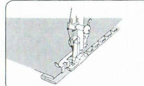
Поднять прижимную лапку и поместить ткань под лапку так, чтобы мягкий сгиб опирался против стенки направляющей подогнутого среза.
